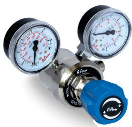
Рамповый регулятор давления серии RPB4 с мембраной из нержавеющей стали является отличным решением для работы с неагрессивными газами. Большой ассортимент конфигураций, типов входных и выходных подсоединений, экономичность и удобство использования обеспечивают возможность применения для очень широкого круга задач. Наличие предохранительного клапана гарантирует высокую степень безопасности. На корпусе регулятора давления есть четыре резьбовых отверстия для простоты крепления на панель.
