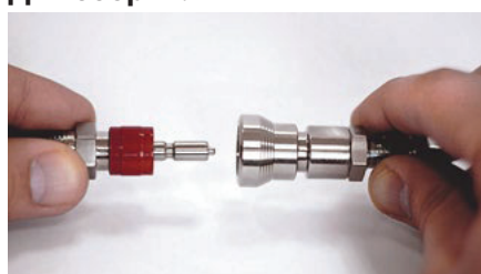
Расположите тело и штуцер на одной оси
