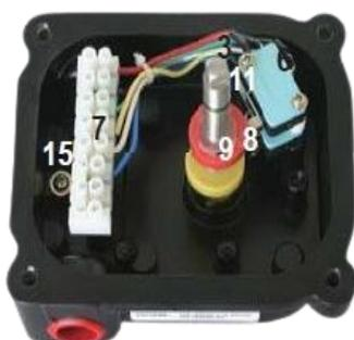
Корпус блока концевых выключателей ALS300 выполнен в общепромышленном исполнении. Корпус из алюминиевого литья под давлением с дихроматное покрытие с порошковым полиэфирным покрытием. Уплотнение: кольцо Buna N. Двойной кабельный ввод 2x1/2"NPT (опционально 2x1/2"BSPP, M20x1,5). Крепление ISO, вал NAMUR, IP67, NEMA 4 4X.
