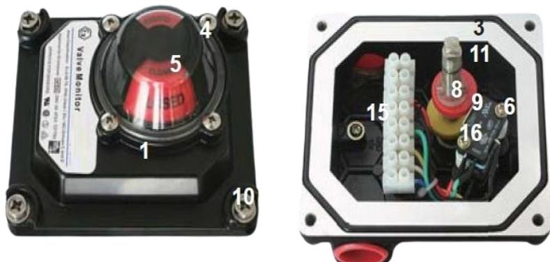
Корпус блока концевых выключателей ALS500 выполнен в общепромышленном исполнении. Корпус из алюминиевого литья под давлением с дихроматное покрытие с порошковым полиэфирным покрытием. Уплотнение: кольцо Buna N. Двойной кабельный ввод 2x3/4"NPT (опционально 2x1/2" или 3/4" BSPP, 1/2"NPT, M20x1,5). Крепление ISO, вал NAMUR, IP66, NEMA 4 4X, взрывозащищенный Ex D
