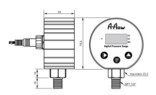
Высота корпуса без штуцера 75,5 мм Высота шестигранной части штуцера 12 мм Высота резьбовой части штуцера 18 мм Шестигранник под ключ 22,2 мм Толщина корпуса 44 мм Резьба штуцера: NPT 1/4"
