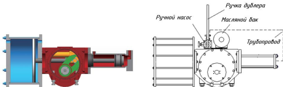
Гидравлический дублер с приводом двухстороннего действия
